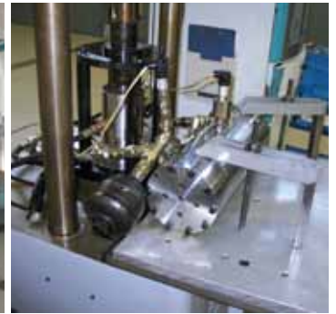
▼ v.l.n.r.: Prüfkammer des 4.000 bar Hochfrequenzpulsers & 500 bar Hochfrequenzpulser
