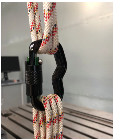
Prüfaufbau einer Karabinerprüfung mit „geschlossenem Schnapper“
