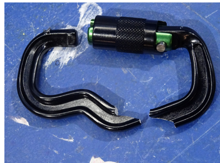
Gebrochener Flugsportkarabiner nach durchgeführter Prüfung
