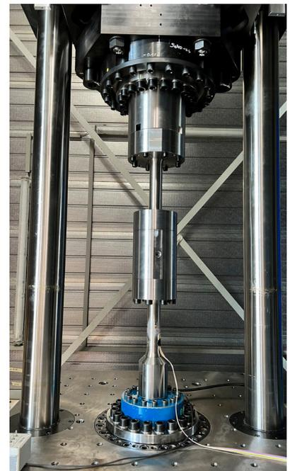
Patentierte Hochdruck-Prüfeinrichtung für dynamische Versuche unter Wasserstoffatmosphäre
