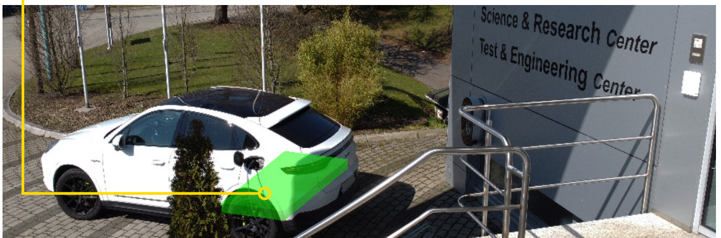
Beispielhafter Aufbau des Prüfsystems mit rollbarem Arbeitstisch, hier zur Prüfung einer Hybridfahrzeugbatterie mit sechs Aktuatoren
