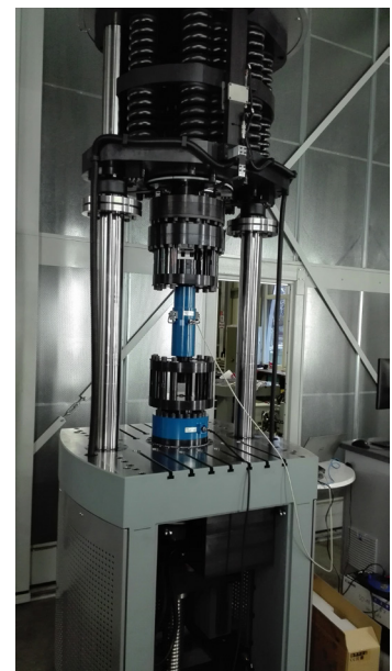
Kalibrierung eines Resonanzprüfstandes POWER SWING MOT
