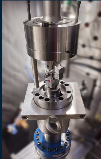
SincoTec Wasserstofftestzelle mit einer CT-Probe
