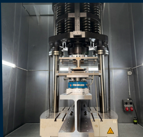
Abbildungen: 4-Punkt-Biegeversuche an Schienen mit einem POWER SWING MOT evolution 600 kN
